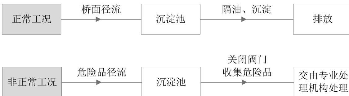
图 7.1-1 桥面径流处理流程图
