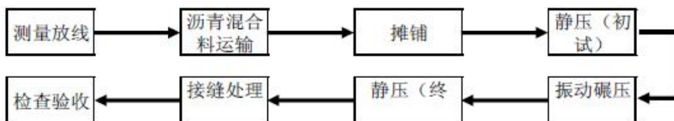
图 4-3 沥青路面施工流程
