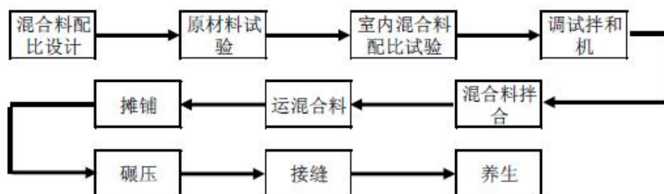
图 4-2 水泥稳定层施工流程图
