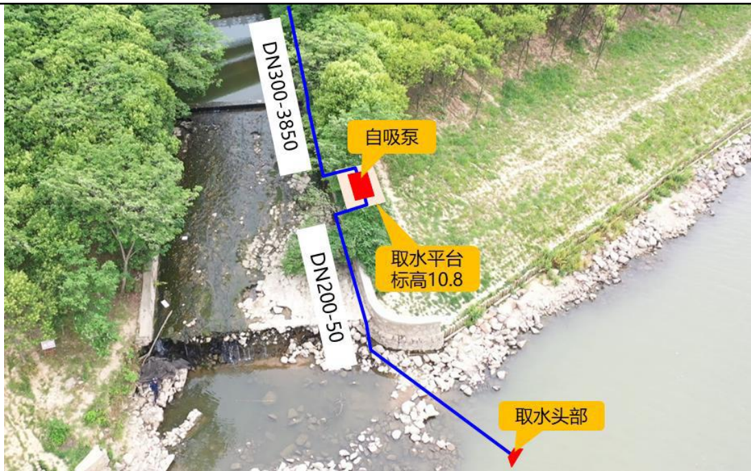
图 2-20 取水头选址及自吸泵位置图
