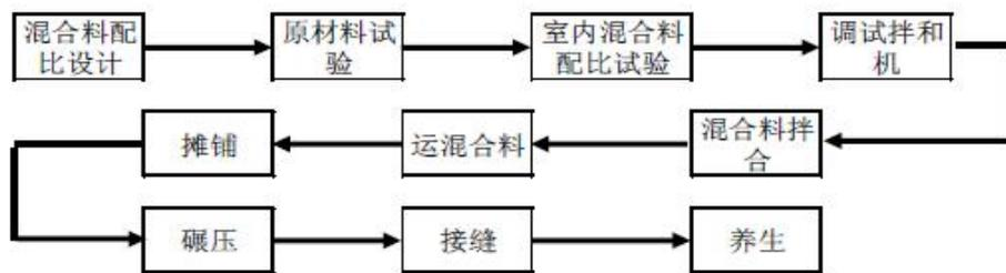
图 4-3 水泥稳定层施工流程图
